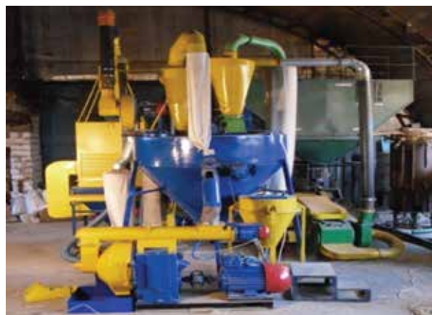
Fig. 4.5. Utilaj de brichetare și peletizare, producător local, productivitate 400–750 kg/h
