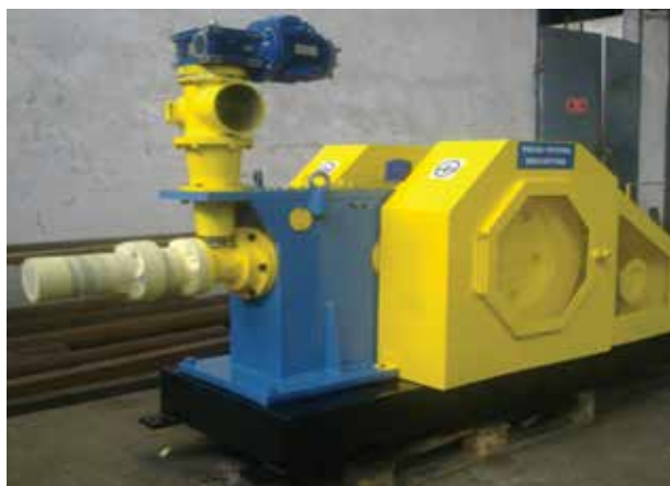
Fig. 4.5. Utilaj de brichetare și peletizare, producător local, productivitate 400–750 kg/h
