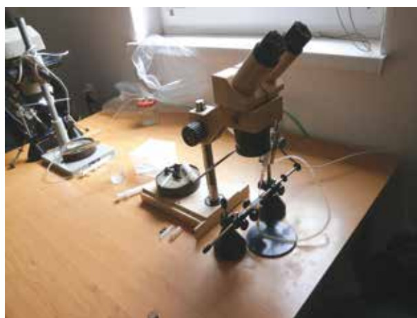
Figura 21. Aparatul de însămânțare instrumentală a mătcilor de albine, cu microscop
