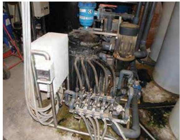
Foto 8. Pregătirea soluției de nutrienți pentru plantele cultivate fără sol folosind o instalație automată de fertigare pentru controlul CE și pH-ului soluției de ieșire
