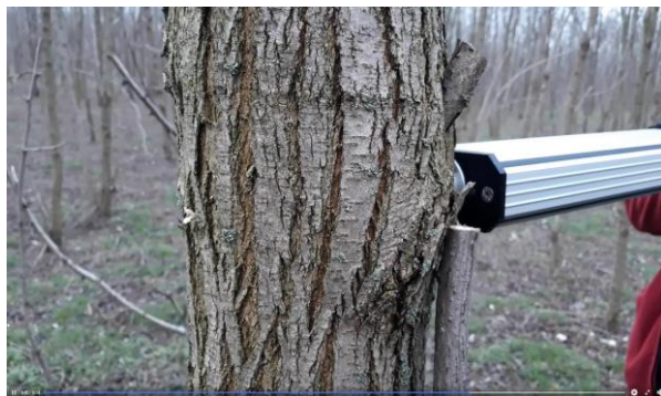
Figura 61. Utilizarea rezistografului în scopul determinării creșterilor radiale. Sursa: Niță și Candrea 2019
