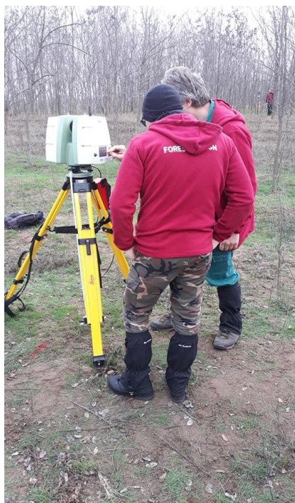
Figura 60. Scanarea arborilor cu scannerul fix (stânga) și cu cel mobil (dreapta) Sursa: Niță și Candrea 2019
